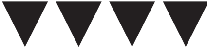
Figura Il 443 - C.d.S. - Art. 144 STRISCIA TRASVERSALE DI DARE PRECEDENZA E' formata da triangoli con la punta rivolta verso i conducenti in arrivo ed è complementare del segnale verticale "Dare precedenza".
