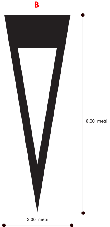
Figura Il 442/a Reg. - C.d.S. - Art. 148 SIMBOLO SULLA PAVIMENTAZIONE Triangolo elongato complementare del segnale verticale DARE LA PRECEDENZA SU STRADE DI TIPO A-B-C-D
